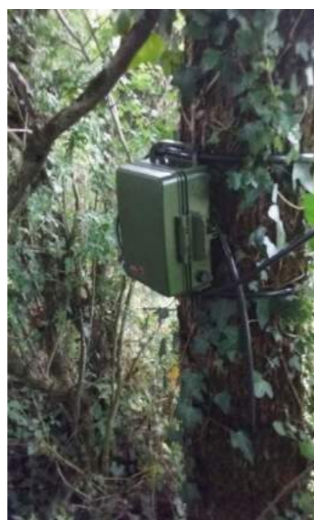
Figure 194 : Installation d'enregistreur continu SM4BAT (Source : NCA Environnement)
